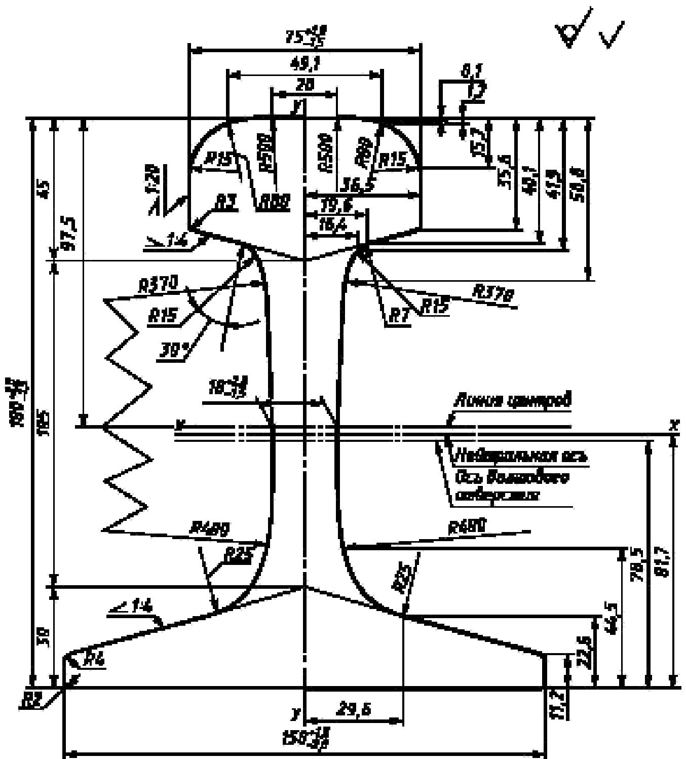
Рисунок 2 – Поперечное сечение рельса типа РП65
