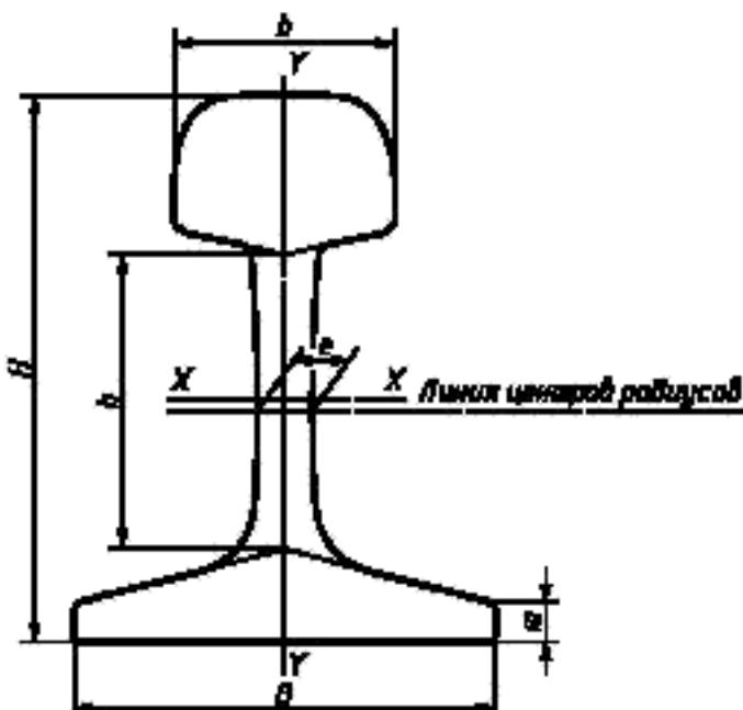
Рисунок 1 — Основные размеры поперечного сечения рельса
