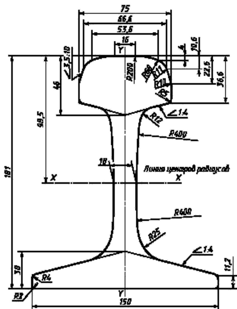
Рисунок А.3 — Рельс типа Р65К
