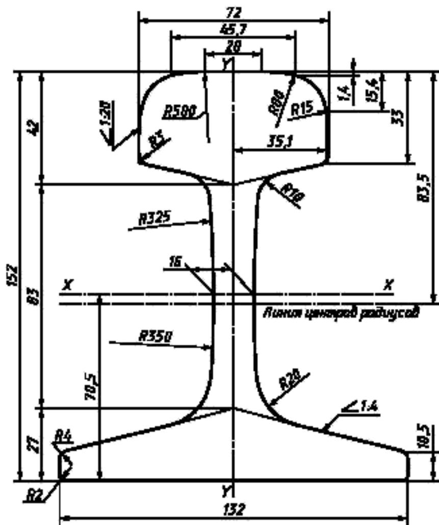
Рисунок А.1 — Рельс типа Р50
