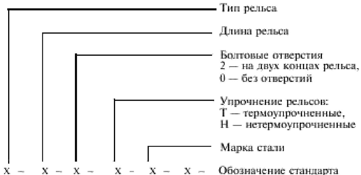
Пример условного обозначения рельса типа РП65, длиной 25 м, с болтовыми отверстиями на двух концах (2), термоупрочненного (Т), из стали марки 76Ф:
