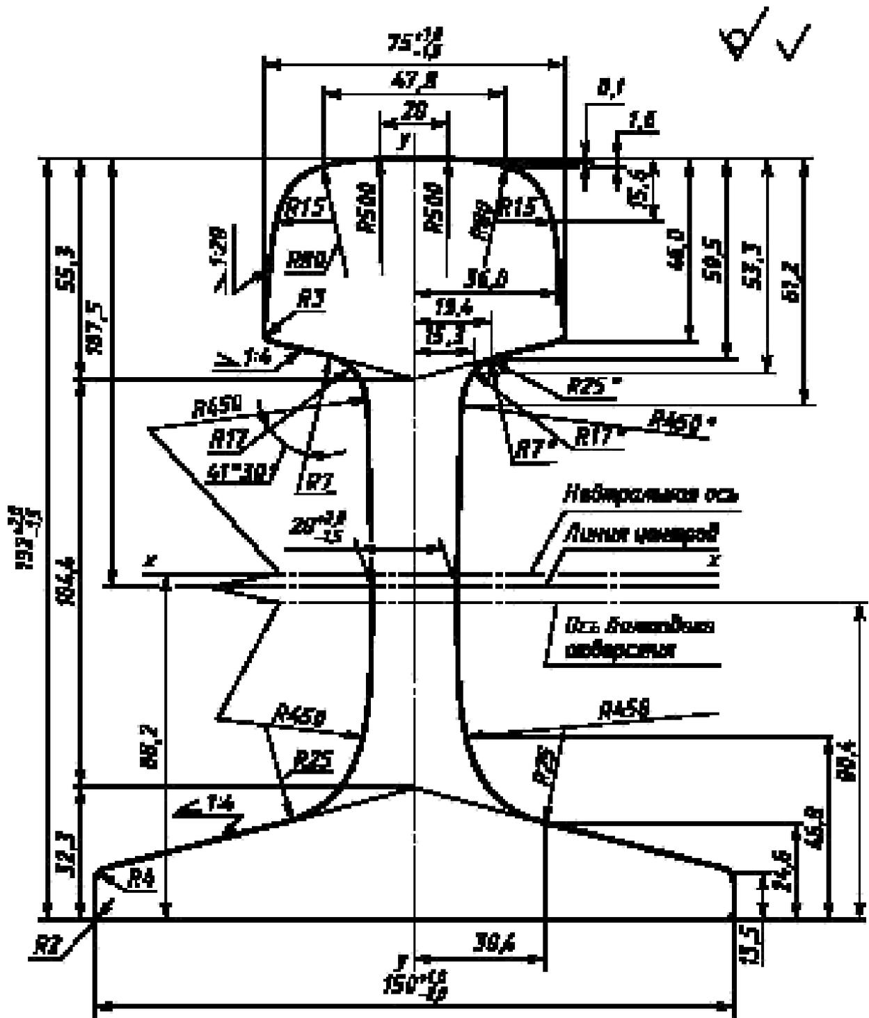
Рисунок 3 — Поперечное сечение рельса типа РП75
