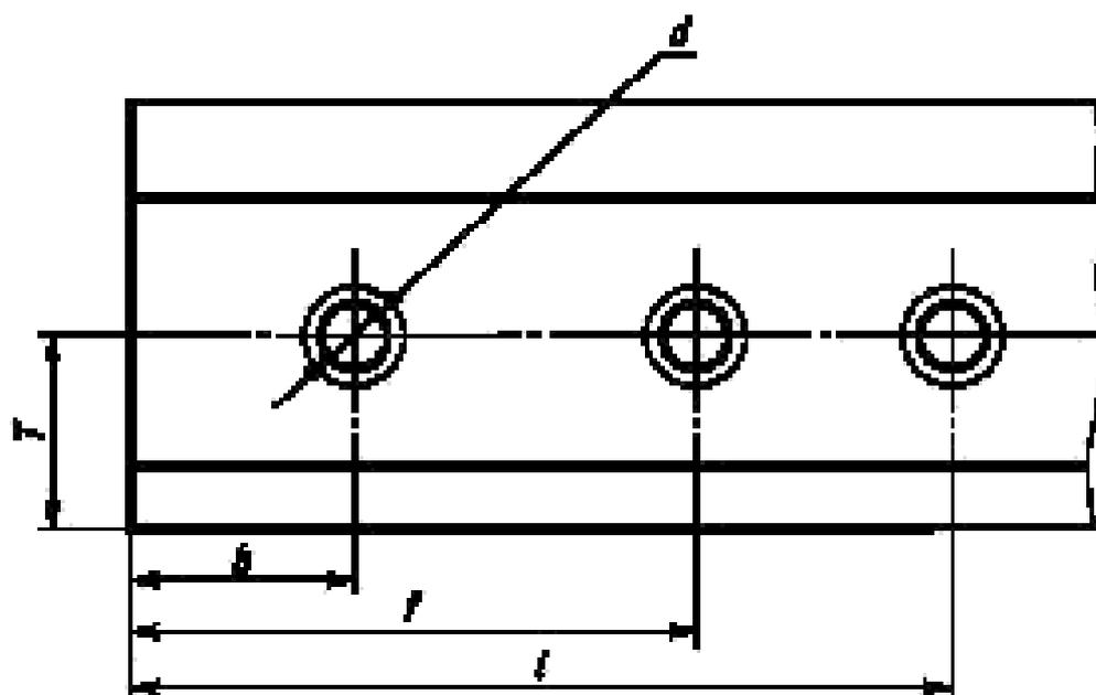
Рисунок 4 — Расположение болтовых отверстий на концах рельсов
